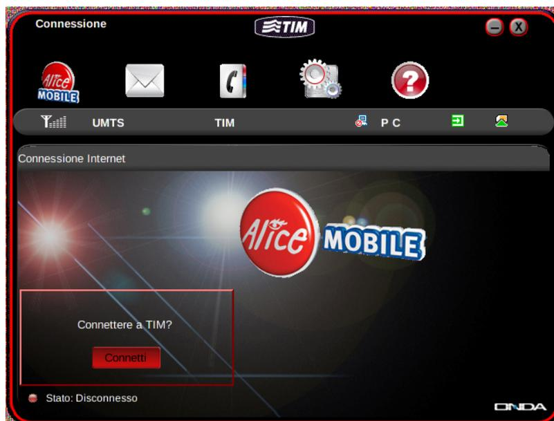
8. Se entrambe le icone in alto a destra risultano “Verdi” e la dicitura “PC” è visualizzata al centro della barra è possibile avviare la connessione premendo il pulsante “Connect”;
